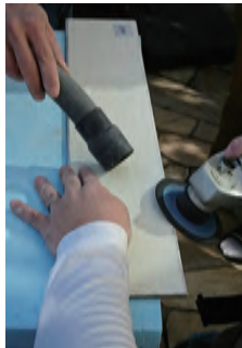
面取り：ワンダーシャープ +ハイラップ使用 加工後小口にガリレオ塗布
